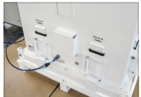
Wasserdampfdichter Behälter bei Dichtheitsprüfung durch Überdruck
