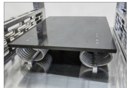
Aufnahmetisch, schwingend gelagert mit Gummipuffer oder Drahtseildämpfer
