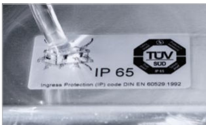
Strahlwasserschutz nach Norm IP 65
