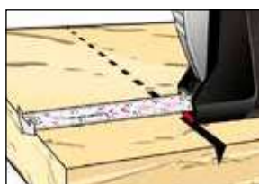
Les bords de mesure et de marquage sont combinés et permettent de transférer la mesure directement sur l'élément à travailler.
