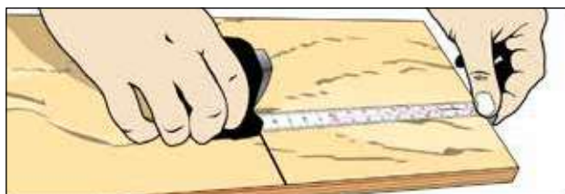
Outre la mesure par la lecture du mètre, la longueur peut être inscrite directement sur l'élément à travailler. L
