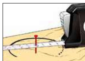
Le ruban peut être utilisé comme boussole, en dessinant des arcs précis d'une seule main.
